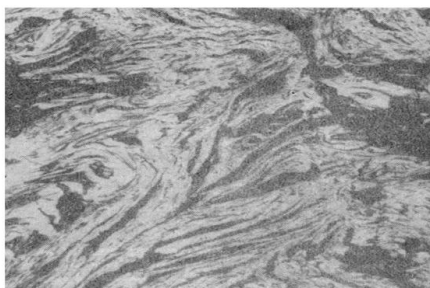
д) микрофотография нефтяного игольчатой структуры, \times 50
